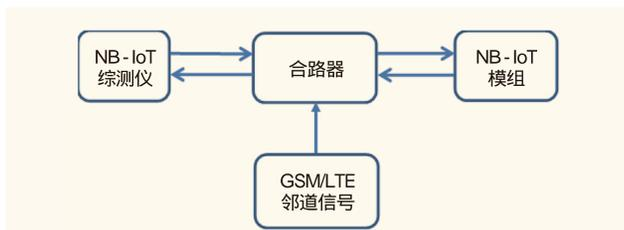
图5 综测仪组成的NB-IoT系统兼容性测试系统
