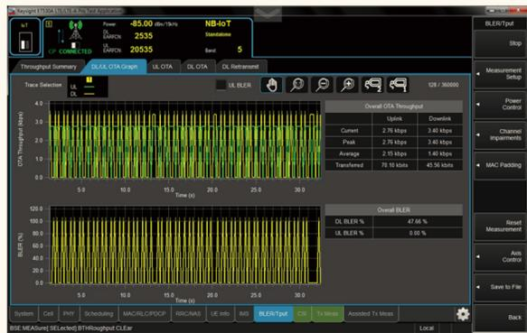
图6 NB-IoT独立工作模式时与GSM信号的干扰分析
