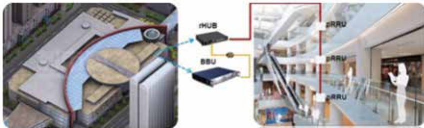
图2 基于小基站的华为LampSite系统
