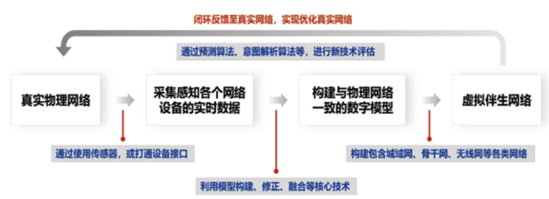
图2 构建伴生网络的基本流程
