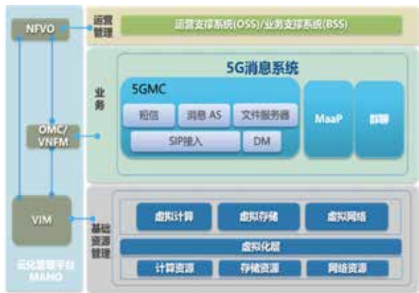
图2 5G消息系统方案架构
