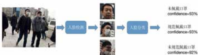
图2 采用检测+分类的算法识别口罩佩戴情况
