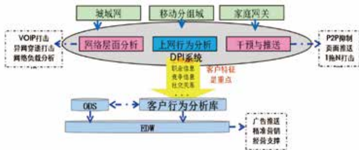
图1 DPI系统流程示意图
