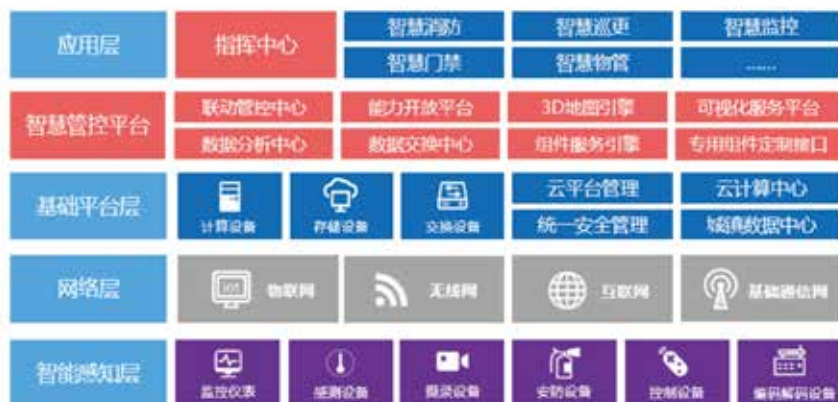
图1 亚信软件智慧城镇管控平台整体架构
