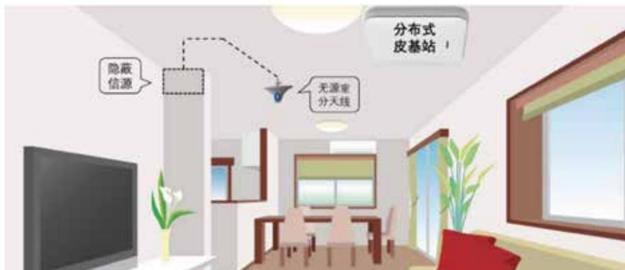
图6 纯分布式皮基站与融合室分设备安装
