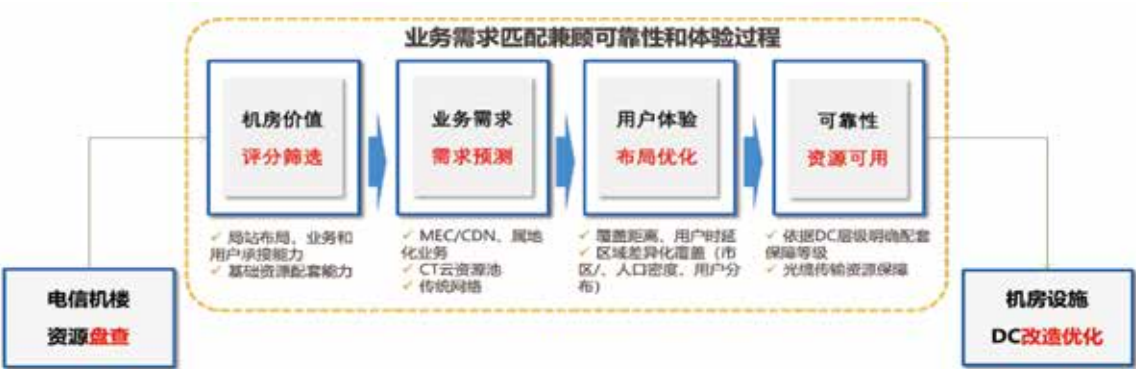
图3 边缘数据中心的业务匹配流程
