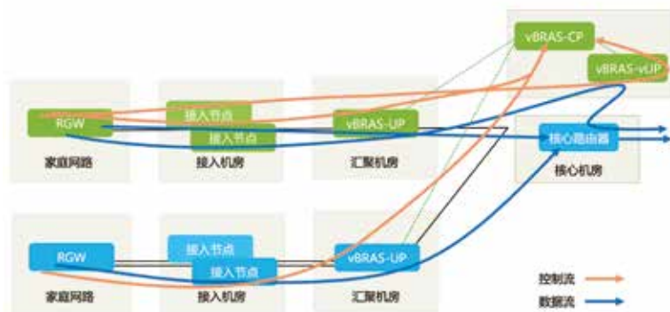
图5 转控分离云化BRAS系统的部署方式
