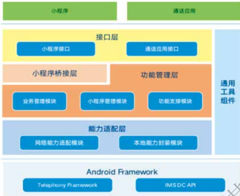
图4 VoNR+终端侧小程序业务生成框架
