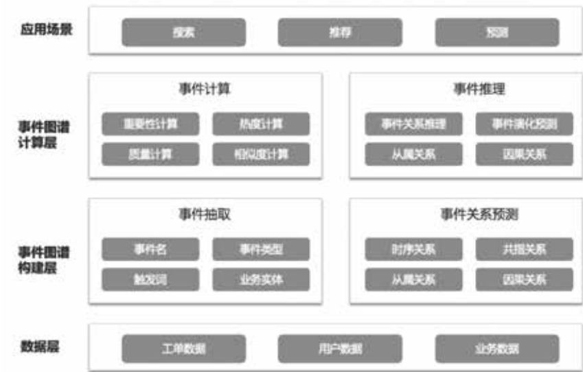
图1 面向用户潜在不满预测的事理认知图谱技术架构
