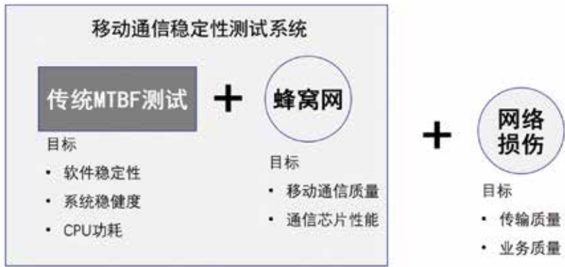
图1 模拟网稳定性测试系统方案架构
