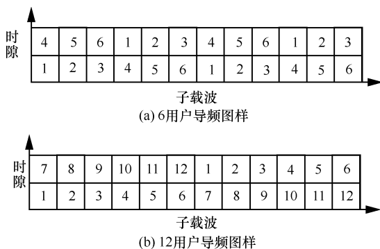
图4 RE-Sparse SCMA FDM 导频图样设计
