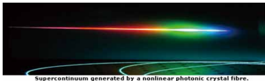
图3 非线性光子晶体光纤产生的超连续光谱
