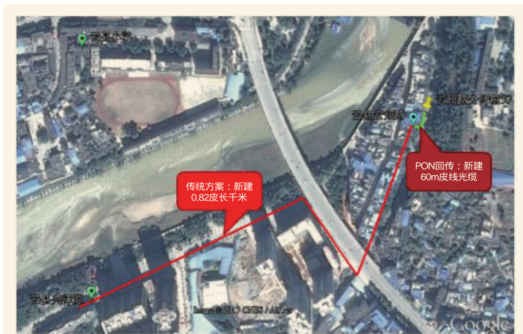
图6 云县云州路PON回传站点实例
