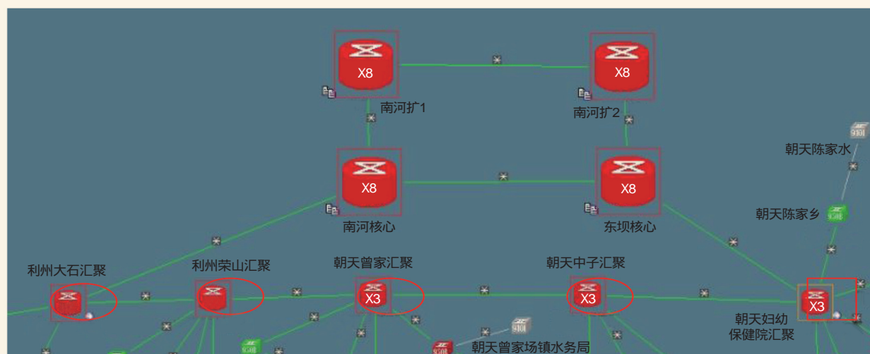
图2 朝天汇聚区一级汇聚结构网络示意
