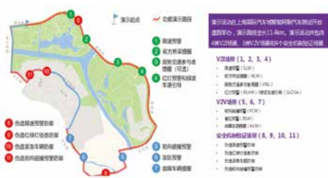
图3 “四跨”测试路段和场景
