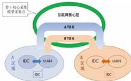
图4 互联网流量骨干核心采集模型
