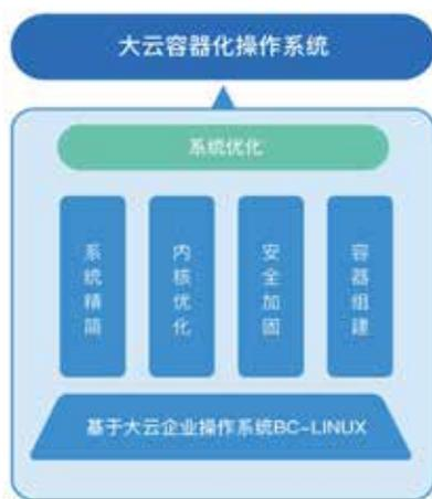
图1 大云容器化操作系统架构
