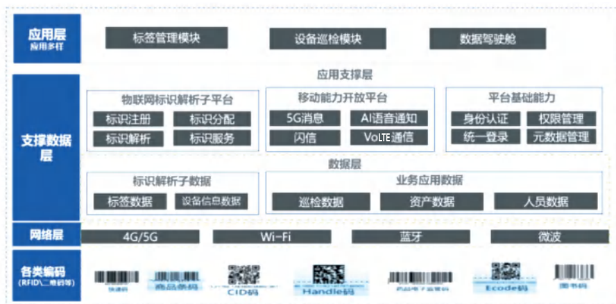
图2 基于物联网技术的设备标识管理系统业务架构
