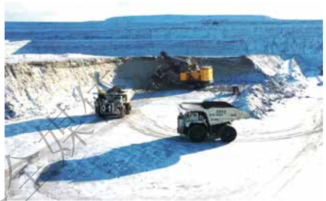
雁宝能源宝日希勒露天煤矿无人驾驶矿卡编组作业
