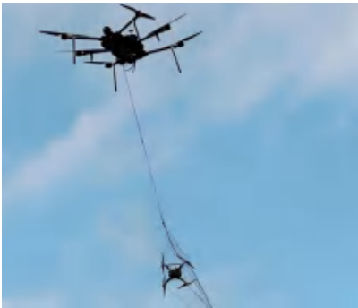
▲ 图3.15 机载网捕无人机（图片来源于互联网）
