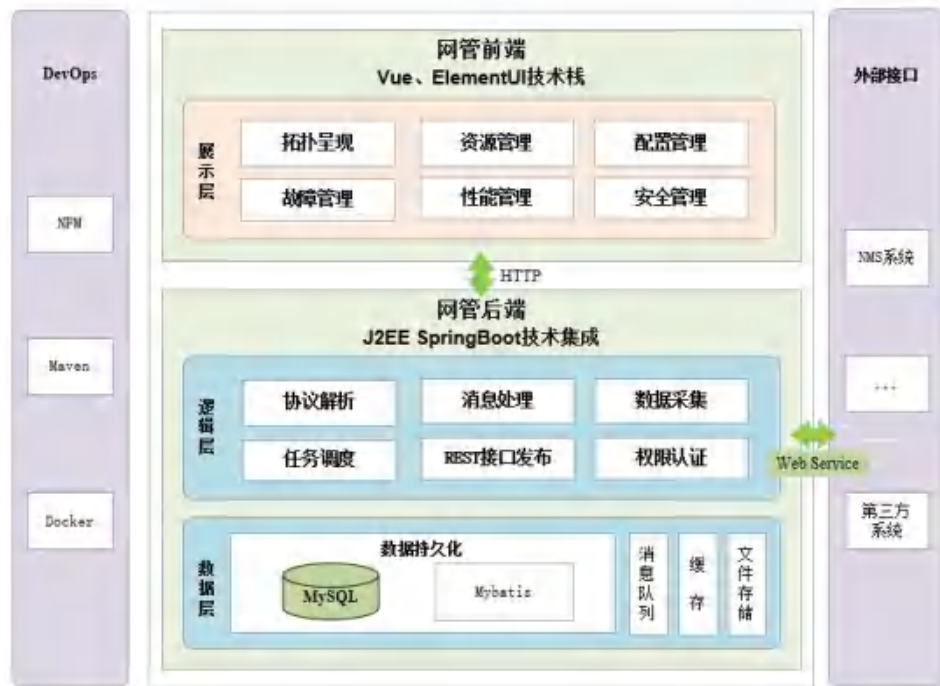
图 2 同步管控平台技术架构
