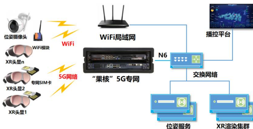
图 16 “果核” 5G+Wi-Fi 混合组网串流传输解决方案
