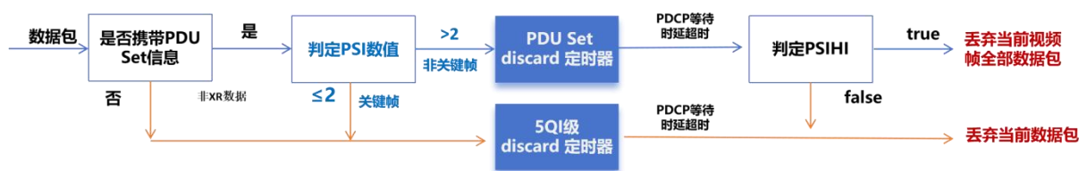
图 9 非关键帧丢弃流程示意图
