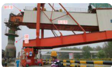
图 3-2 装船机远控及 AI 预警
