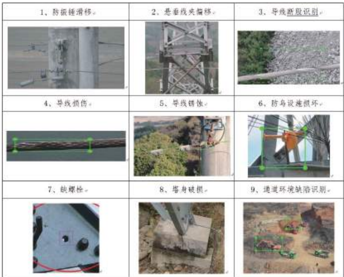
图 8-4 杆塔本体缺陷识别示意图
