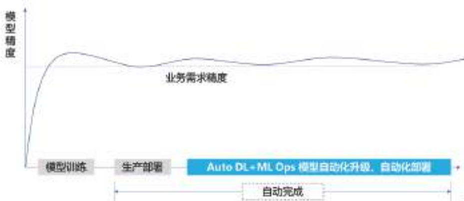
图 5-4 自适应 AI 质检系统自学习的模型精度
