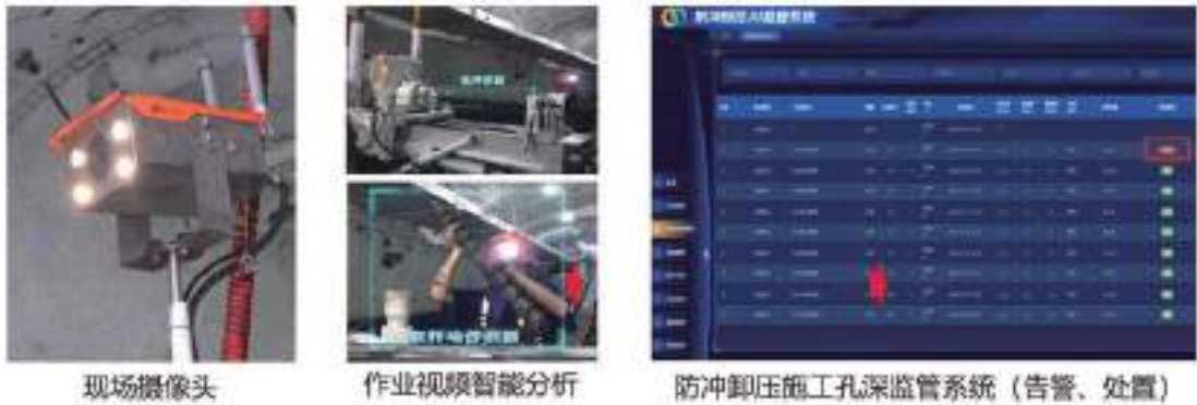
图 6-6 防冲卸压施工孔深监管部署示意
