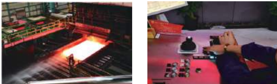
图 6-13 宽厚板粗轧转钢监测画面 & 人工转钢操作
