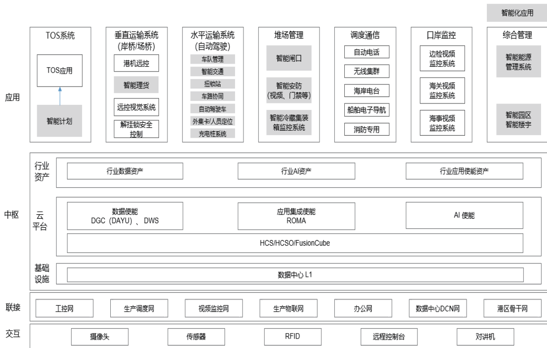
图 11-3 天津港 C 段码头整体架构
