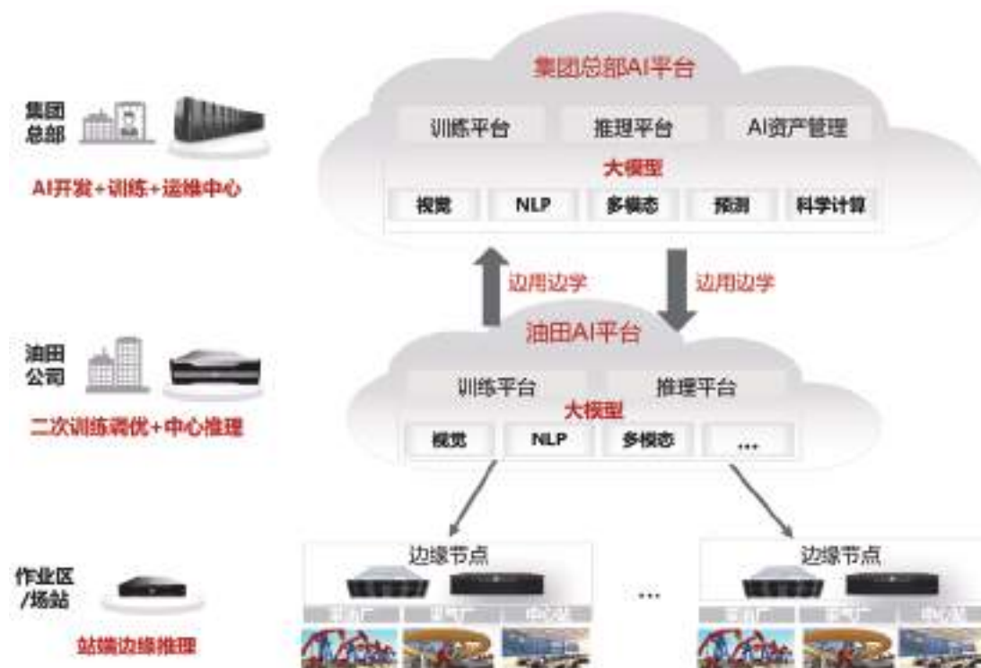
图 9-3 云边协同部署架构
