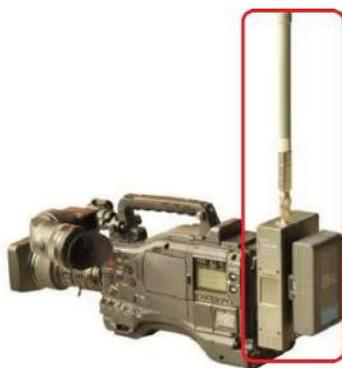
图 4. 安装微波接收器后的摄像机
