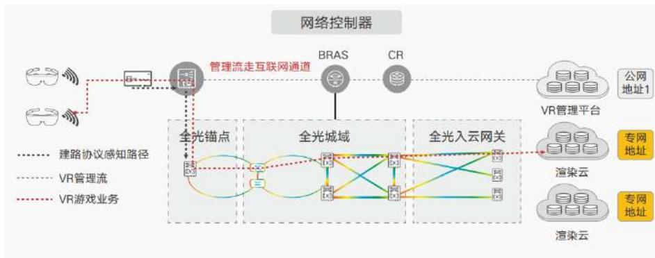
图 33 OTN 承载 CloudVR 方案架构
