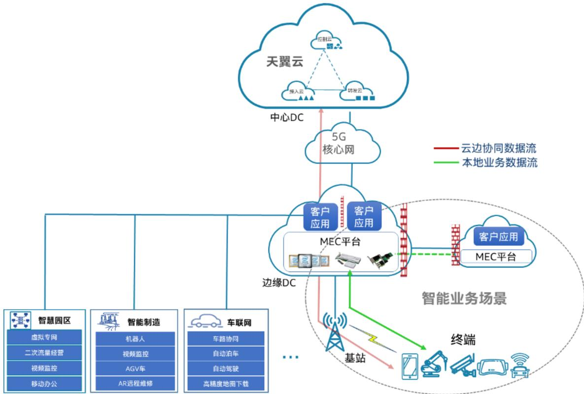
图 5 中国电信 MEC 平台应用部署架构
