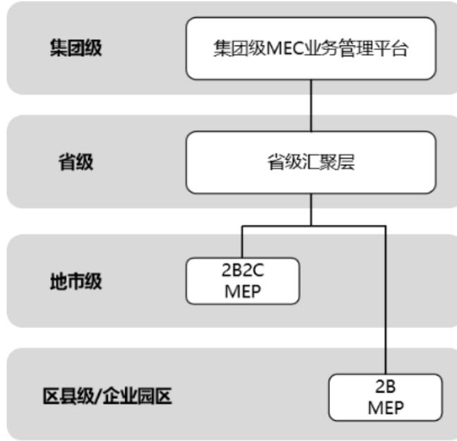
图 2 中国电信 MEC 总体部署架构
