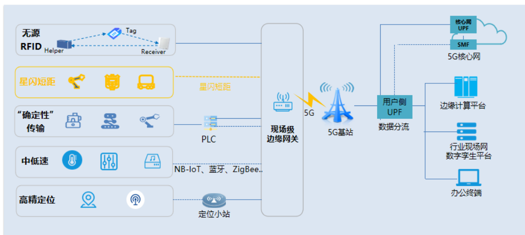
图 3-1 5G 融合工业现场网技术总体架构
