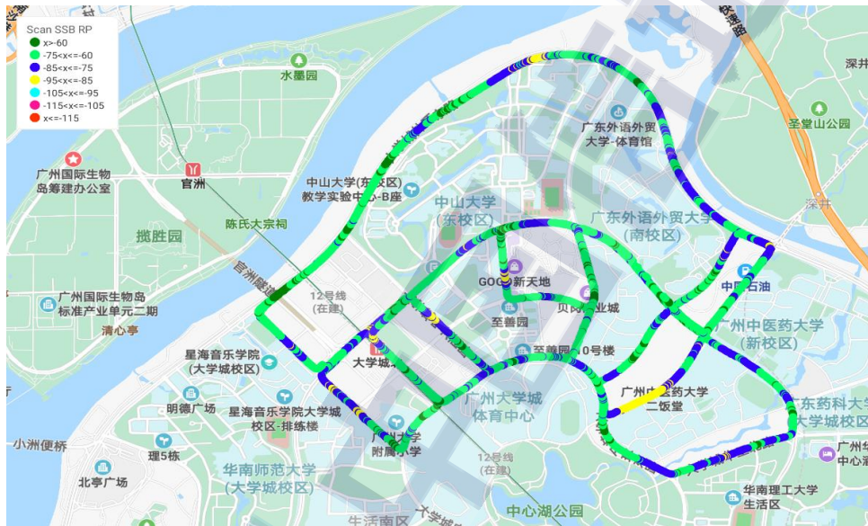
图 6 主要道路 5G 网络覆盖打点示例图（广州大学城路段）
